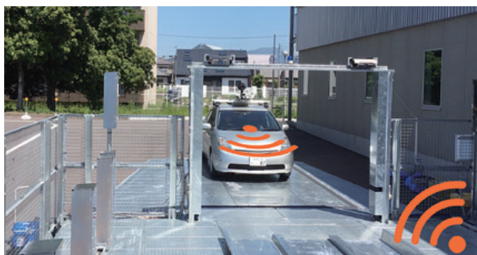
駐車許可の信号を自動運転車に送信する機械式駐車設備
