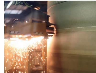
商用車用ホイールを9秒に1個の速さで製造することが可能な世界トップクラスの生産性を誇ります。商用車用ホイールのリム材には、カーボンニュートラルの実現に有効な当社の電炉材を使用しています。当社の異形鋼圧延技術により、リム材の強度を保ちつつ極限まで薄くすることで軽量化を図り、燃費向上に大きく貢献しています。また、当社独自のECOD成型により製造したディスクは一般的な製法よりも廃材を大幅に削減することができ、省資源化に貢献しています。
