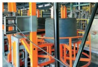
高密度に巻き取ったコンパクトコイルを伸線しNC加工機に投入
