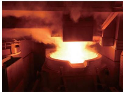
豊橋製造所の製鋼工場は、老朽化が進んでいた設備を新鋭化し、南海トラフ地震の発生を想定した災害に強い供給体制を備えて2015年3月に稼働を開始しました。国内最大級200トンの環境対応型高効率電気炉(ECOARC™※)の導入と、その後の炉内雰囲気制御など、ECOARC™炉の特長に合わせた操業方法に変更。独自の技術とノウハウを活用した操業改善により、省エネ・コスト低減効果を実現し、さらなる電極原単位の低減につながっています。製鋼能力増加による安価な夜間電力のみでの操業、ブルーム・ピレット兼用連続铸造機導入による棒鋼用ピレットの自給化など、国内トップレベルの環境対応・競争力を持つ製鋼工場となっています。
