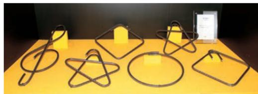
NC加工機による加工例
