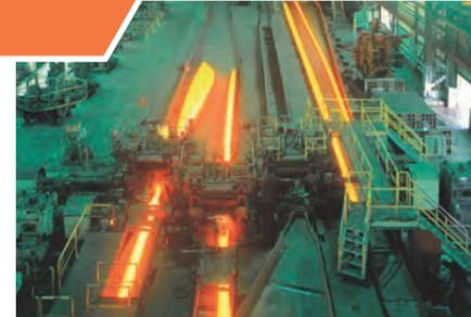
当社独自の数値解析を駆使した異形鋼製造技術は当社の強みの一つです。断面が上下左右非対称な異形鋼は、矩形断面（長方形の断面）から異形断面に加工すると変形の強い側から弱い側に曲がりが生じます。これを斜行ローラーの搬送力を利用して真っ直ぐに修正することができる特殊生産ラインを有しているため、効率的に複雑な断面形状の異形鋼の製造を可能にしています。
