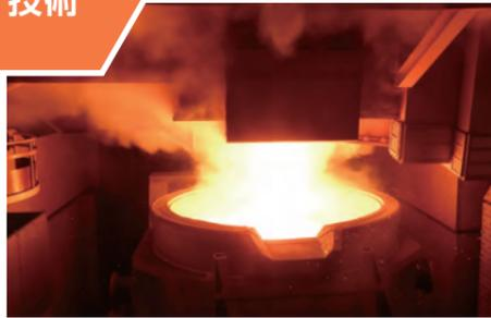
豊橋製造所の製鋼工場は、老朽化が進んでいた設備を更新・新鋭化し、2015年より本格稼働を開始しました。新鋭化にあたっては、南海トラフ地震の発生を想定した地震・津波対策の実施により、災害に強い供給体制を確立するとともに、国内最大級200トンの環境対応型高効率電気炉「ECOARC™」を導入し、さらなる「省電力」と「生産性向上」を実現しています。さらに、ブルーム・ビレット兼用連続鑄造機導入により棒鋼用ビレットを自給化するなど、国内トップレベルの環境対応・競争力を持つ製鋼工場に生まれ変わりました。
