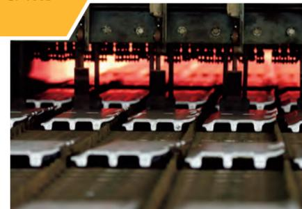
独自開発した熱伝導解析システムに基づき、加熱と冷却を繰り返すことで、強度、耐摩耗性や強靭性を高める技術を実現しています。また、世界最速のリンク加工ラインや、他社には見られないリンクベルトの自動組立ラインの開発により、安定した品質と低コストの履帯を世界中に供給しています。
