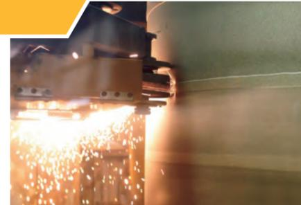
トラック・バス用ホイールを9秒に1個の速さで製造することが可能な世界トップクラスの生産性を誇ります。スチールホイールのリム材には、当社が製造した異形鋼を使用しています。当社では、リム材の強度を保ちつつ極限まで薄くすることで軽量化を図り、燃費向上に大きく貢献しています。また、当社独自のECOD成型により製造したディスクは一般的な製法よりも廃材を大幅に削減することができ、省資源化に貢献しています。
