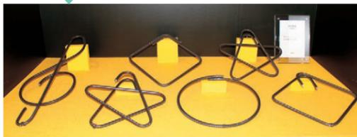
NC加工機による加工例
