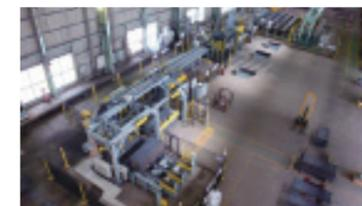
トンネルセグメント用継手板自動加工ライン
