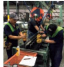
そこで、在庫スペースの削減と仕様変更への対応力を強化するために、鉄履帯とシティーパットを在庫し、必要に応じてシティーパット履帯を組むこととし、そのためシティーパット取り付けラインを導入しました。
