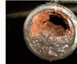
コンプレッサの冷却水配管に大量のスケールが附着し、性能の低下を引き起こしていました。
