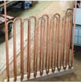
▶シンター3,4号炉 給水加熱によるボイラー燃料の削減
