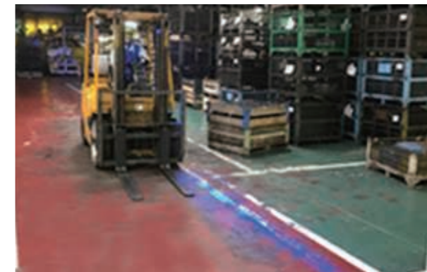
フォークリフト安全対策 (ブルースポットライト設置による被視認性向上)
