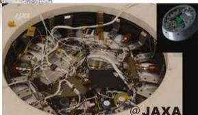
IMASENの航空宇宙事業を手がける東洋航空電子株式会社では、ロケットの打上支援設備や試験装置の他、衛星やロケット本体への搭載品も取り扱っています。2018年9月23日、種子島宇宙センターからH-II B7機で「こうのとり (HTV)」の搭載品として打上げられ、11月11日午前7時頃、国際宇宙ステーション (ISS) での実験成果が、JAXAが国内独自技術を駆使して開発した回収カプセルで地上に持ち帰られました。この回収カプセルには、東洋航空電子が組立や試験を担当したコンピュータ (SOBC: Small Onboard Computer) が搭載され、大気圏突入直前から海上着水までの間、通信や姿勢制御などの重要な役割を担いました。SOBCは小型衛星用のコンピュータとして開発され、今後打ち上げ予定の衛星用SOBCの製造と試験を行っています。今回の回収カプセル帰還の大成功が弾みとなり、更に夢のある計画への参画ができることに期待しています。
