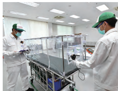
負圧可動式ベッド製作の様子
