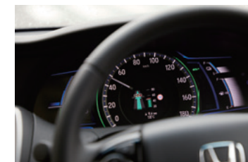
信号情報から車速の維持や減速などの情報を表示するマルチインフォメーション・ディスプレイ
