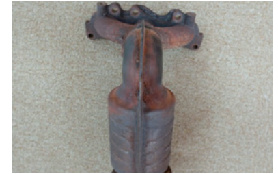
1999年製「ライフ」排気マニホールドの割れ
