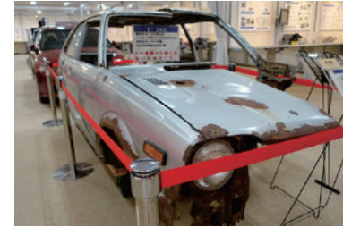
1981年製「シビック」の車体のさび
