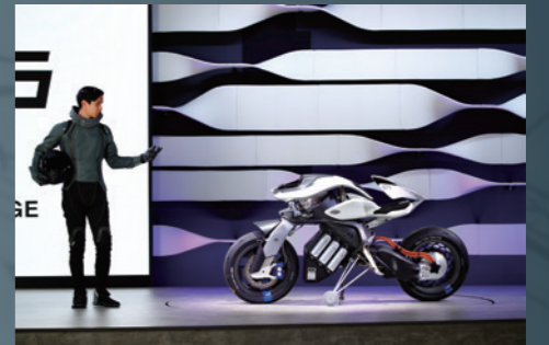
画像認証AI: 顔認識機能によりオーナーのみに反応するシステムです。ジェスチャー認識機能も備え、手招きなどのしぐさをキーに走行などの動作開始、停止が可能です。
