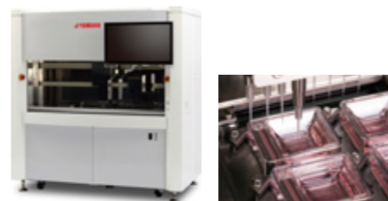
CELL HANDLER™(セルハンドラー) 産業用ロボット(表面実装機)の技術を応用し、医療分野へのソリューションを提供
