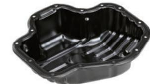
エンジン下部に配置され、エンジン部品の潤滑に必要なエンジンオイルの一定量の保持と外部への流出を防ぐ機能をもつ部品です。高いプレス技術により、エンジンとの接合部の平面度や密閉性を実現しています。
