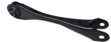
タイヤと車体の間に配置され、タイヤの姿勢を決める重要保安部品です。タイヤからのさまざまな力に耐え得る強度、剛性が不可欠となります。高いプレス技術により一体構造のリンクを開発し、強度、剛性を満足させながら軽量化に貢献しています。
