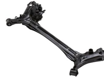
小型、中型乗用車の後輪側サスペンションの主流形式であり、中央部のクロスビームがねじれることで、左右のトレーリングアームが別々に動き、独立懸架式に近い特性が得られる部品です。さまざまな構造に対応することで、軽量化に貢献しています。
