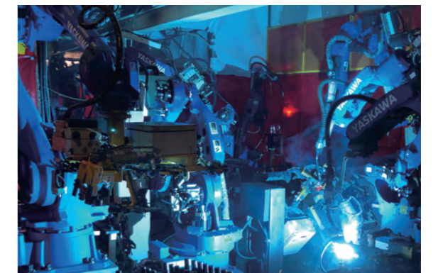
YAA（ヨロズオートモーティブアラバマ社）の溶接全自動ライン
