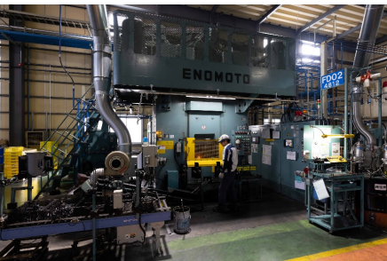
当社独自工法のスクリュープレス式熱間鍛造
