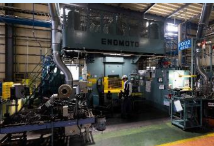
当社独自工法のスクリープレス式熱間鍛造
