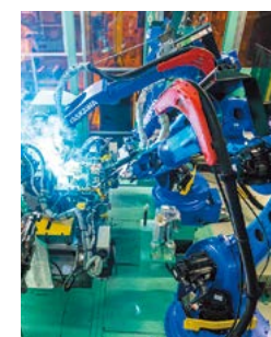
自動溶接設備
