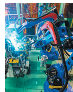
自動溶接設備
