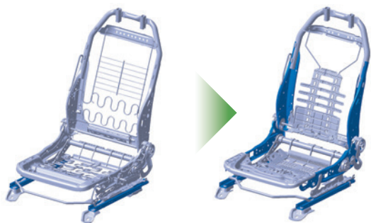
フレームにおける超高張力鋼板採用部品（青色部分）の変遷
