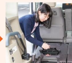
車椅子の前輪を格納するため、床のパネルをはずす
