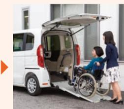
スロープを引き出し、電動ウインチで車椅子を引き上げる
