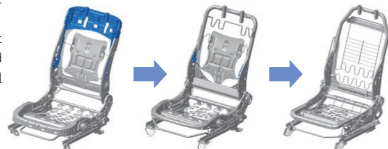
フレームにおける頸部傷害値低減の機能部品の変遷
