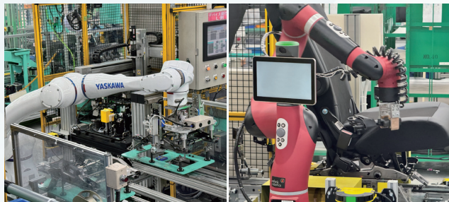
シートレールやシートベルトバックルの自動締結工程
