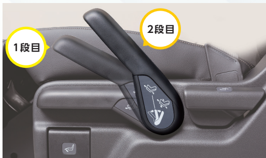
1段階目:前後スライド解除/2段階目:横スライド解除
