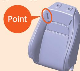
部分のように溝を設け、着座時にシートを意図的にたわませることで、安全性と快適性を高めている。
