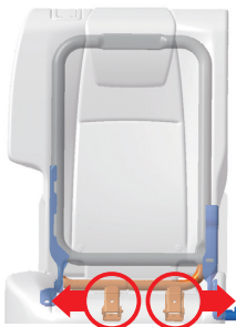
図2 リアシートフレーム アレンジ機構部品(オレンジ箇所を外側に設計)
