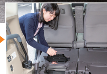
車椅子の前輪を格納するため、床のパネルをはずす
