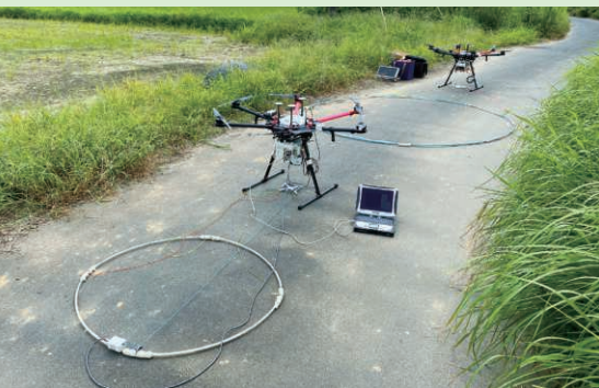
2機のドローンを使った空中電磁探査(実業務で世界初の試み)
