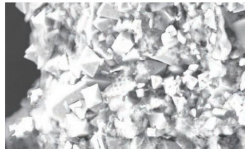
酸性水の発生原因となる黄鉄鉱の電子顕微鏡画像
