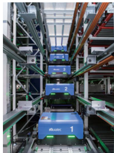
ユニシャトル(高速自動入出庫装置)
