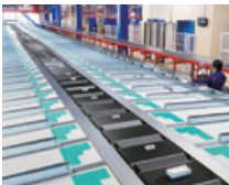
クロスベルトソーター (お客様別高速仕分け装置)
