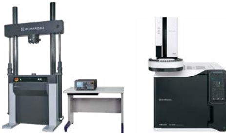
水素関連部品の強度検査 疲労・耐久試験機
