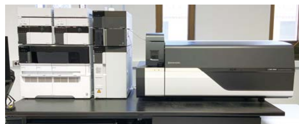
ワシントン大学との共同研究に用いている高速液体クロマトグラフ質量分析計 [LCMS-8060]
