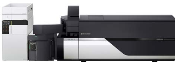
研究で使用している液体クロマトグラフ質量分析システム [Nexera Mikros]
