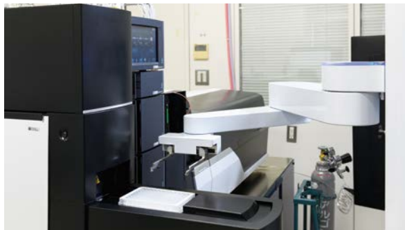
自律型実験システム(Autonomous Lab)のロボット対応液体クロマトグラフ
