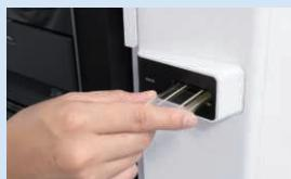
「LC-2030C NT」に搭載されている「スライドインカラム」取付に工具を必要とするカラムでは、作業によって結果に差が生じることがありますが、スライドインカラムは工具なしに、わずか10秒で装着完了。初心者でも信頼性の高い結果が得られます。
