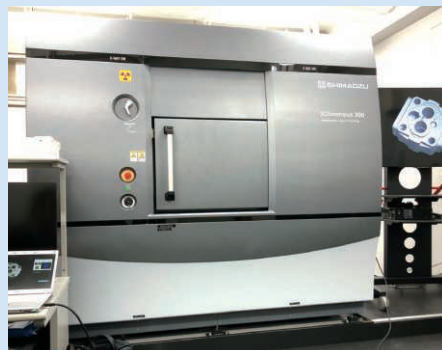
慶應義塾大学に設置されている計測用X線CTシステム「XDimensus 300」
