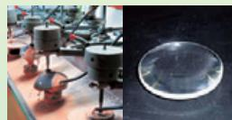
③表面を透明に磨き上げます。面精度によっては、高度熟練技能が必要とされます。
