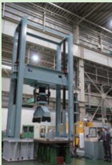
このたび、当社グループの(株)東京衡機試験機の相模原工場では、コンクリート業界向けに「5000kNコンクリートパイル曲げ試験機」を製作しました。コンクリートパイル（コンクリート製の基礎杭）は、様々な土木・建築構造物の基礎工事で使われる建築資材で、軟弱な地盤を補強するために地中深くまで打ち込んで建造物を支え、地震発生時の建物倒壊や地盤沈下を防いでいます。本機は主にコンクリートパイルの曲げ強さ試験を行う大型試験機で、床上高さ7m、床下基礎部1.2m、本体重量40トンの堅牢な構造を備え、5000kN（およそ500トン）の試験力を発生させることができ、直径1.2m、曲げ支点間隔9mまでの大きく長いパイルの試験が可能となっています。本機の開発においては、専門的な知識を要する各種設計、高精度大型シリンダーの製作、高所組立作業など様々な難問を解決して完成に漕ぎつきました。
