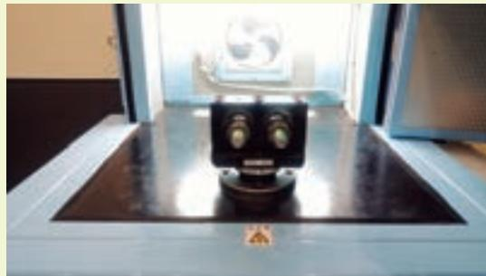
振動試験機のカバーの中の試験体 (ゆるみ止めナット)
