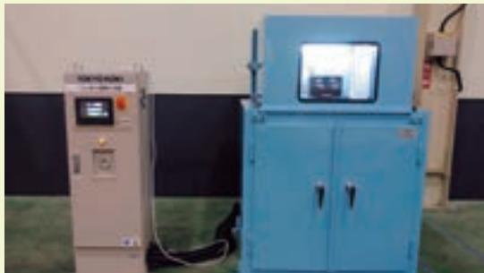
振動試験機本体 (右) と制御装置 (左)
