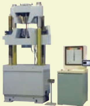
油圧式万能試験機（左）と荷重指示操作装置
