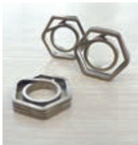
ロックワンは、ばねの緊縮力を利用したスプリング構造のボルト・ナット脱落防止締結具です。標準の12角ソケットにナットとロックワンをセットし、通常のボルト締め付けの要領で取り付けられるなど作業性が良く、また、脱落防止効果が極めて高いことが特長です。NAS 3350 (National Aerospace Standard 米国宇宙航空規格) に準拠した衝撃型振動試験において脱落防止効果は証明されており、また、第三者機関が実施した他社製品との比較試験においても高い評価を得ています。
