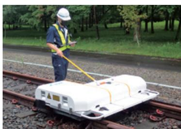
鉄道機器: 分岐器検査装置
