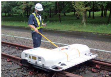
鉄道機器: 分岐器検査装置
