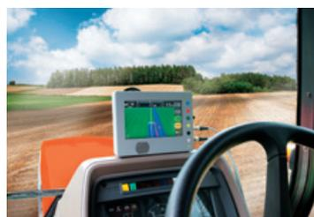
農機用GNSSガイダンスシステム
