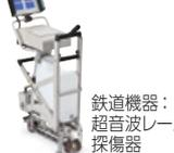
鉄道機器:超音波レール探傷器
