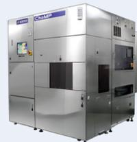
高圧・高速研磨によりSiCウェーハの研磨レートを向上
