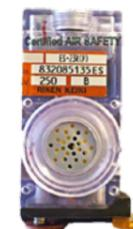
半導体工場向けガス検知器の製品化に寄与した定電位電解式センサ「ES-23シリーズ」(1987年開発)
