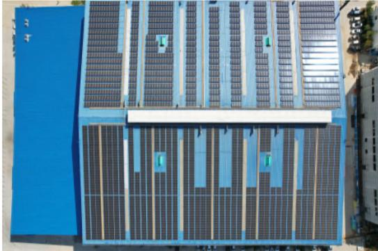
HOYA OPTICAL TECHNOLOGY (WEIHAI) CO., LTD.に設置した太陽光パネル（年間発電量：約1,300MWh、年間CO<sub>2</sub>削減効果：約800t-CO<sub>2</sub>）
