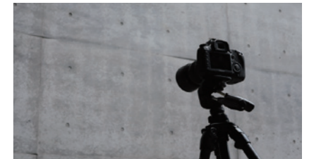
キャノン製カメラを用いて点検対象物を撮影
