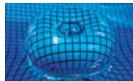
光硬化型インクを使用して印刷したシートを延伸加工した様子
