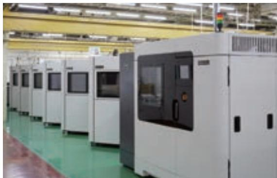
3Dプリンターによる直接製造サービス設備(RICOH Rapid Fab 厚木)
