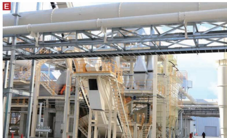
建物(画像C)でふるい分けを行ったのち、パーティクルボード向けに選別された木材チップはフレーカーという機械を通して適度な大きさに揃えます。その後、**ドライヤー(画像E)**を通して乾燥させ、木材チップの含水率を調整します。
