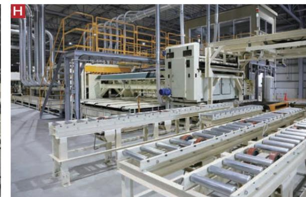
**画像Hの建物の中には、PBの原板を最終製品に仕上げる設備**として、表面を平滑にするためのサンダー(左)や、ご注文に応じて寸法決めを行うためのマルチカットソー(右)などがあります。
