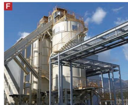
乾燥工程を経た木材チップは、その後さらに、異物除去等の工程を経て、**画像Fのチップサイロ**に一時ストックされます。サイロに蓄えられた木材チップは、次に**画像Gの建物の中にあるフォーマー**という機械を通ります。このフォーマーでPBの元になる材料マット(接着剤を塗布した木材チップ)を成形します。
