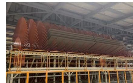
連続プレスを通過したばかりのPBは、かなりの熱を帯びていますので、**画像Gの建物内の巨大なクーリングターナー**を通して冷却します。そして冷ましたPBを**画像H**の建物に運びます。
