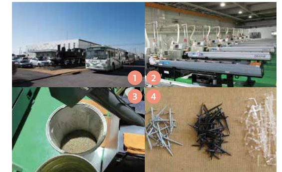
①(株)トミーテック(栃木) ②TOMIXの車輪を作る機械 ③車輪を切削する際に排出される金属くずをリサイクル ④プラスチック成型時に排出されるランナー
