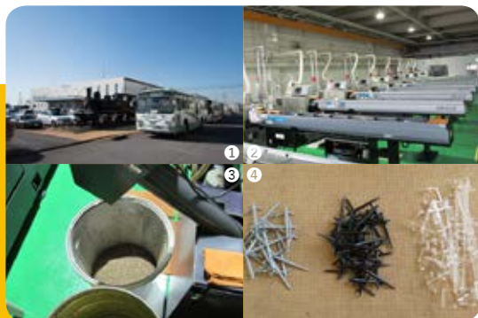
①トミーテック(栃木) ②TOMIXの車輪を作る機械③車輪を切削する際に排出される金属くずをリサイクル④プラスチック成型時に排出されるランナー
