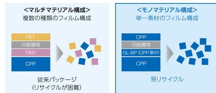
国や地域によって様々な容器包装のモノマテリアル化ニーズに対応するため、PET、PE、PP各種フィルム基材に独自のバリア技術を組み合わせたGL BARRIERを開発・製造
